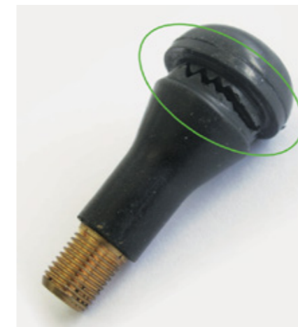
Überaltertes, abgerissenes Ventil
